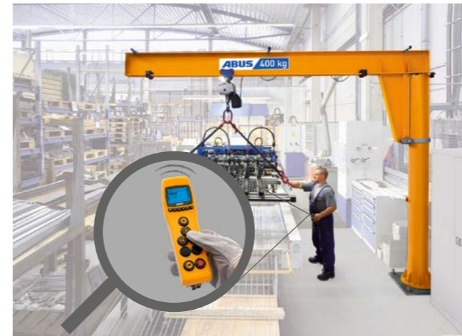
Commande radio ABURemote (image 12)
