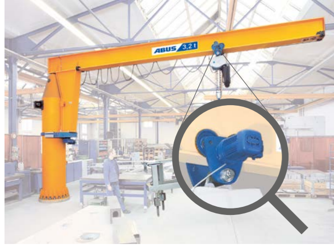
Déplacement électrique du chariot (image 1)
