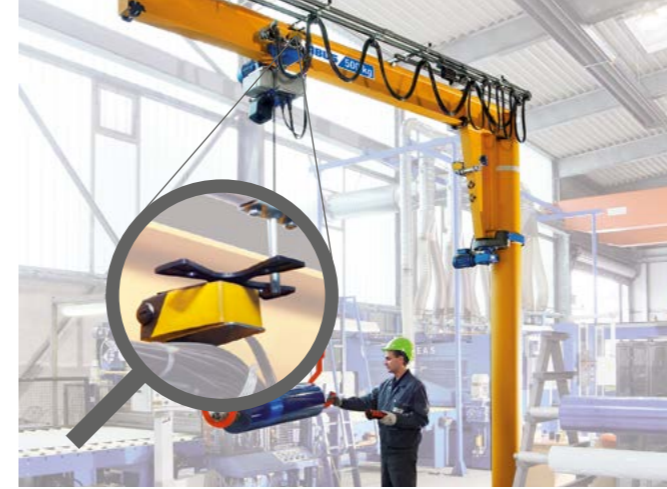
Interrupteur de fin de course du chariot (image 8)
