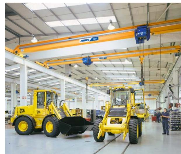
Chariot monorail de type E sur ponts monopoutre ELV
