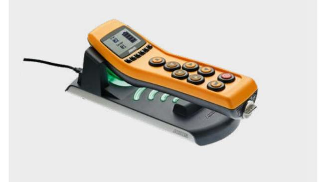
Indication de la charge sur l'écran de la radio commande à boutons ABURemote
