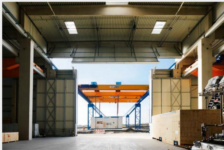
Lors d'un usage en service extérieur, le pont ABUS peut incorporer les asservissements de franchissement des portes ou lanières souples, en toute sécurité.
