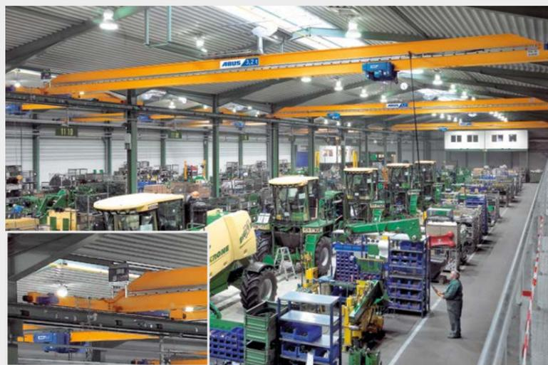
La solution optimale pour des bâtiments neufs : Un pont monopoutre caisson ABUS, type ELK avec la poutre taillée en biseau (variante 3). On utilise au mieux la hauteur disponible sous les fermes, pour une hauteur sous crochet maximum.
