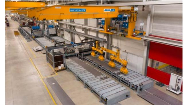
Avant la poursuite du traitement, les plaques sont stabilisées avec des raidisseurs soudés. Un ensemble de convoyeurs automatiques amène les tôles à la seconde phase, qui consiste à la mise en place de raidisseurs longitudinaux et à la mise en géométrie des tôles formant caisson. Le caisson est préassemblé et prêt pour être soudé.
