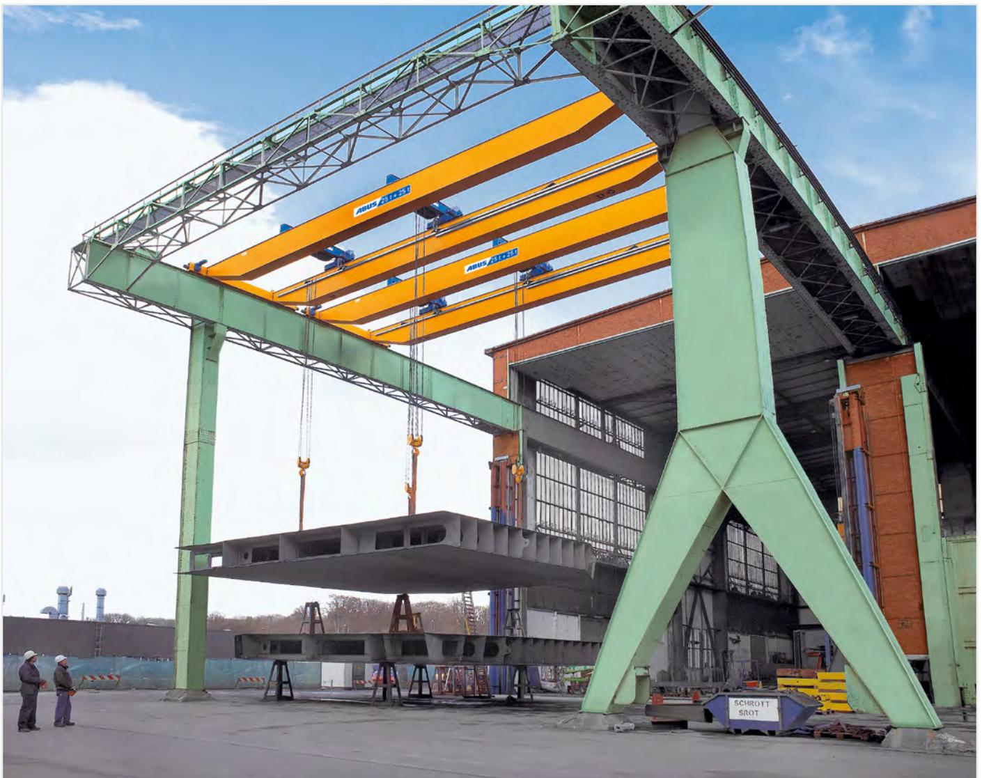
Avec la commande pour marche en tandem ABUControl, ABUS offre une solution professionnelle pour cette application logistique particulière. Elle permet de déplacer deux ponts simultanément à l'aide d'une télécommande. L'utilisateur est libre de se positionner à l'emplacement le plus adapté aux conditions d'utilisation.
