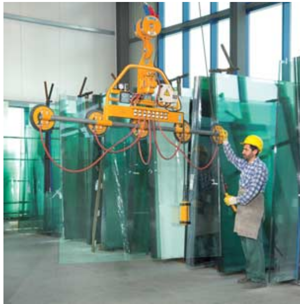
Déplacement avec doigté, lors du transport du verre
