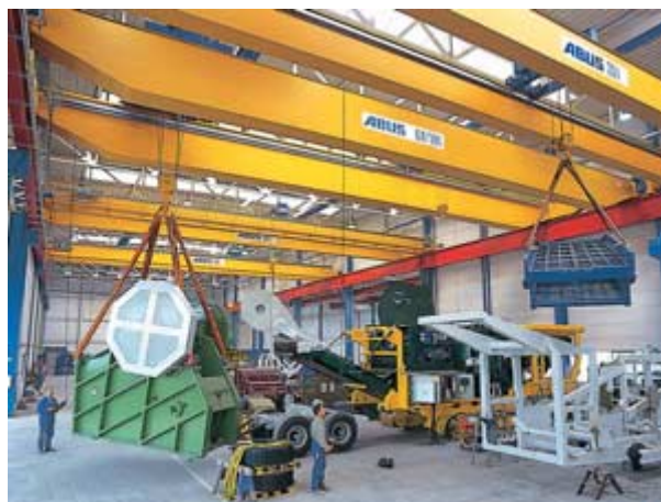
Montage à faibles oscillations de grandes machines
