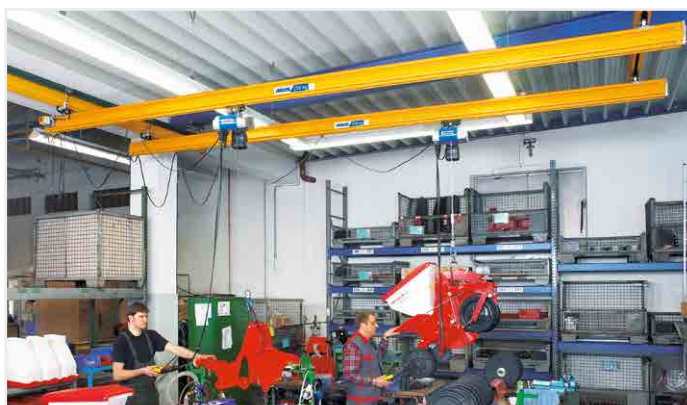
Manutention aérienne, libère votre espace de travail Systèmes HB ABUS jusqu'à 2 t
